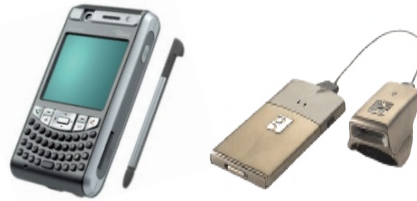
Smartphone e ring scanner connessi tramite bluetooth (soluzione per aggiornamento in tempo reale)
